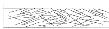
Fig. 6: Fibre i glasfiber med glat overflade. - Fiberkernen plottes hurtigt ved ydre påvirkninger og giver adgang for skadelige bevirkninger bakterier, fugt m.m.
